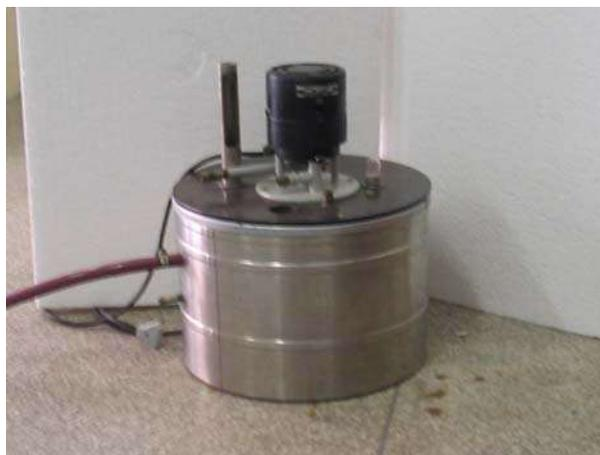
Figura 5.11 – Recipiente para aquecimento da solução salina, IEE/USP (Foto: C. M. Ramos, 2005).
